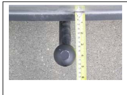
Abstand Kupplungskopf zur Stoßstange
